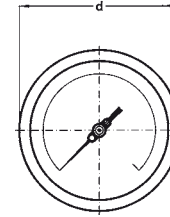
D - POSTERIOR - Modelo standard para montaje local directo
